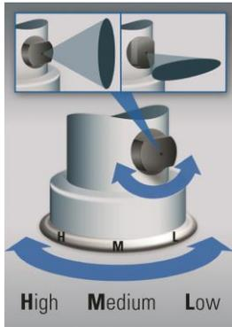
Der Sprühkopf ist zweifach drehbar. Durch Drehen der kleinen schwarzen Düse, kann der Sprühstrahl ausgerichtet werden. Durch Drehen des ganzen Sprühkopfes auf die Positionen **Low**, **Medium**, **High** wird die Sprühmenge reguliert.
