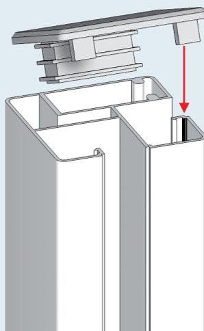
Montieren Sie den Eckpfosten auf einem waagerechten Untergrund. Bitte beachten Sie zum Untergrund die Hinweise in der SYSTEM WPC Anleitung (Art. 4185).
