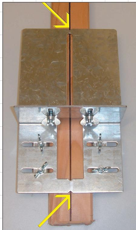
**3** Die Schablone auf die Unterkonstruktion auflegen. Die beiden Einkerbungen (sh. Pfeile) werden am Mittelriß ausgerichtet. Alle Flügelmutter werden locker gedreht (nicht abgeschraubt !).
