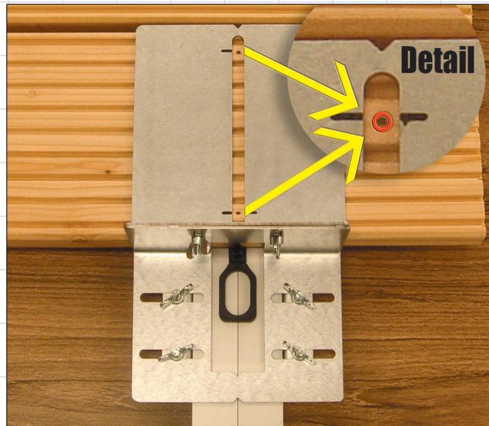
**5** Nun wird die Schablone angelegt. Hierzu die beiden Schrauben (sh. rote Pfeile!) für das Einstellen der Dielenstärke lockern (nicht abschrauben). Die Schablone nun auf die Unterkonstruktion sauber auflegen. Der vordere Teil der Schablone passt sich der Dielenstärke an. Jetzt die beiden Flügelschrauben per Hand an ziehen. Mit einem Stift wird die gewünschte Bohrposition auf der Metalloberfläche links und rechts markiert (sh. gelbe Pfeile!).
