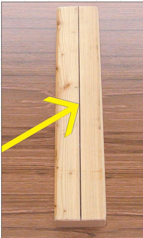
**1** Auf einem kurzen Stück der Unterkonstruktion wird ein Mittelriß (ca. 40 cm lang) angebracht (sh. Foto). Dieser dient zum einmaligen Einstellen der Schablone.
