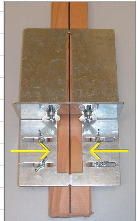
**4** Nun die sich an der Unterseite befindlichen Anschlagwinkel von links und rechts and die Unterkonstruktion heranschieben, bis sie das Holz parallel berühren. Jetzt die Winkel mittels der Flügelmutter per Hand festschrauben. Nochmals prüfen, ob die beiden Einkerbungen (sh. Punkt 3) noch korrekt mit dem Mittelriß übereinstimmen.
