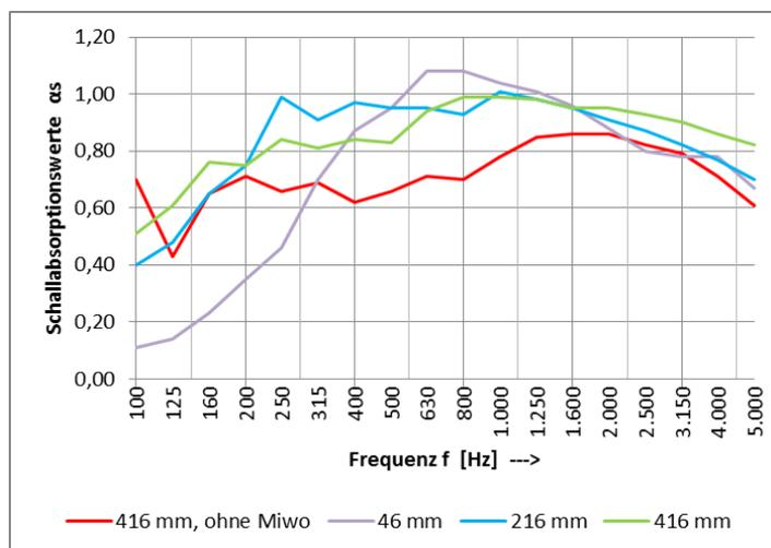
Messungen wurden im März 2015 vom Prüfinstitut BAE Fiedler nach DIN EN ISO 354 „Messung der Schallabsorption in Hallräumen“ Ausgabe 2003 durchgeführt und ausgewertet.
