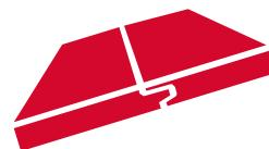
Passgenaue und schnelle Verlegung durch optimiertes **Nut- und Federprofil**.
