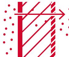
Durch die **Diffusionsoffenheit** kann in Verbindung mit leichten Dampfbremsen auf der Innenseite des Bauteils eine sichere und dauerhafte Konstruktion mit geringem Tauwasserrisiko und hohem Austrocknungspotential hergestellt werden.
