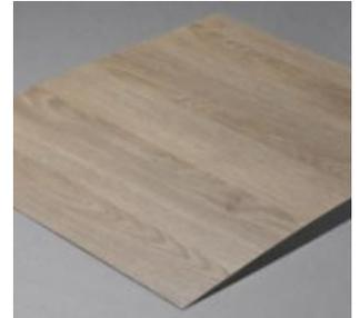
EGGER Schichtstoff XL ist ein dekorativer Schichtstoff auf Basis härtpbarer Harze. Schichtstoff XL ist mehrschichtig aufgebaut, besteht aus melaminharzprägniertem Dekorpapier und mehreren mit Phenolharz imprägnierten Kernlagen, die unter hohem Druck und Temperatur miteinander verpresst werden.
