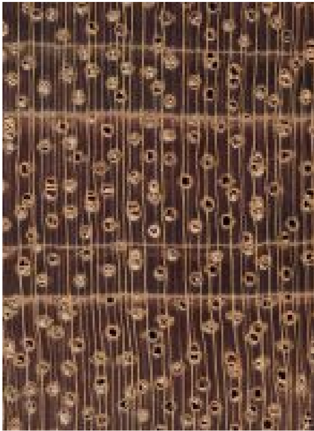
Jatobá ( Hymenaea spp.): Querschnitt (ca. 10x)
